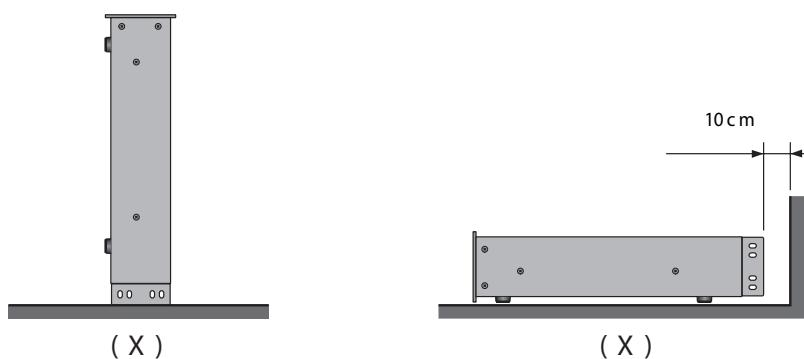
**Примечание:** Во избежание перегрева усилителя не закрывайте вентиляционные отверстия.
