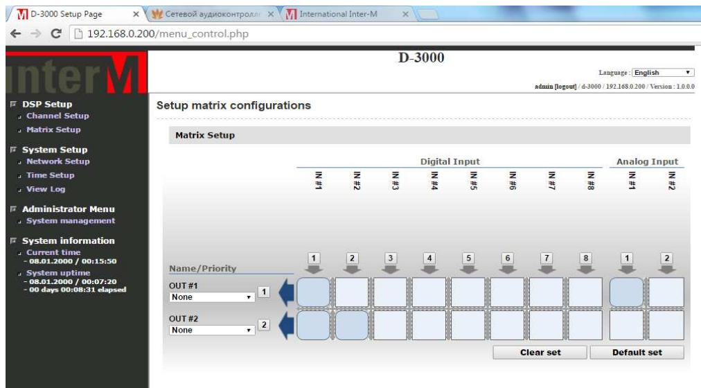
При помощи вкладки Matrix Setup можно микшировать 2 входных аудиосигнала в любой выходной канал. При этом допускаются комбинации цифровых и аналоговых сигналов. Каждый канал звукового усиления настраивается независимо друг от друга.
