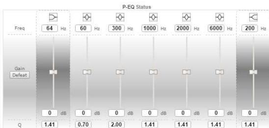
Настройки параметрического эквалайзера P-EQ Status позволяют изменять центральную частоту (Freq), добротность (Q), уровень усиления (Gain) для каждого фильтра.
